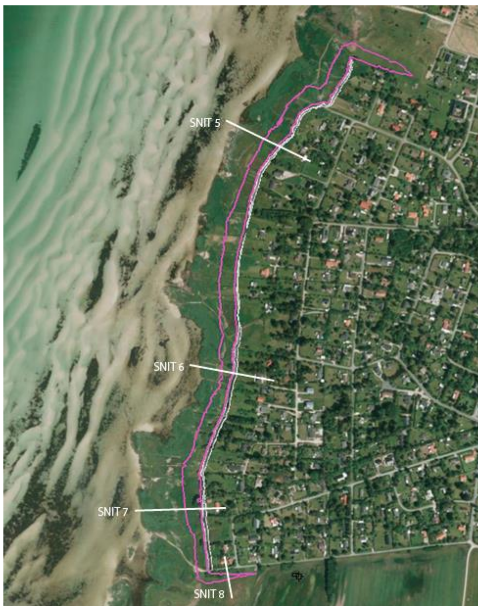
Figur 26 Oversigtstegning af grøftens udbredelse med anlæg 1:5 og 1:3. Digets udbredelse er markeret med en lilla afgrænsning, grøften med grå. På tegningen er markeret placering af tværsnit jf. figur 38.
